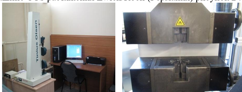
Рис. 2. Испытательные машины Tinius Olsen и UTS Zwick/Roell
