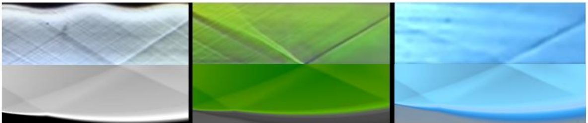
Рис.2 Изображено наложение эксперимента и контуров ANSYS, с разными типами заливок, настроенными в модуле CFD-Post. Наверху эксперимент, внизу модель.
