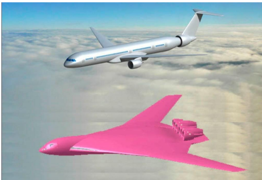
Рис. 5. Модель самолета с распределенной силовой установкой
