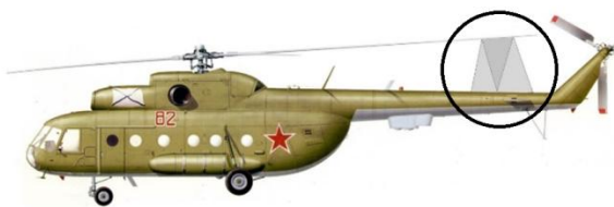
Рис. 1. Схема расположения приемо-передающего модуля на хвостовой балке вертолёта
