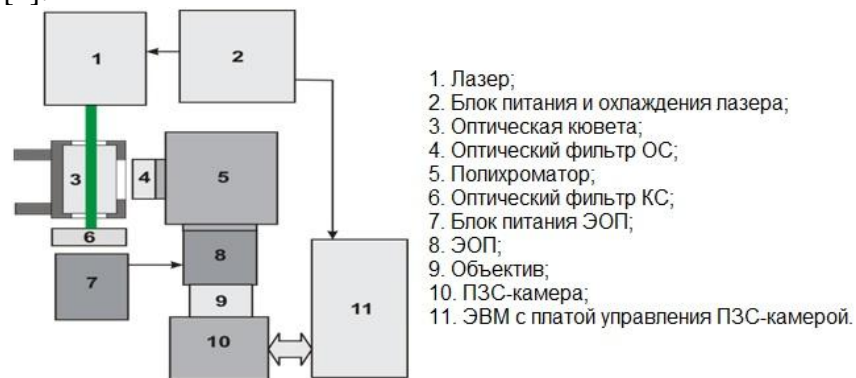
Рис. 1. Оптическая схема установки ЛИФ [2]
