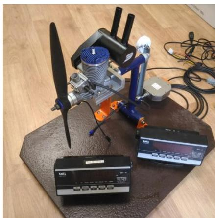
Рис.1. Стенд для испытания ДВС
