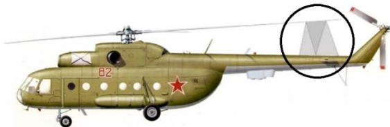
Рис. 1. Схема расположения приемо-передающего модуля на хвостовой балке вертолётa
