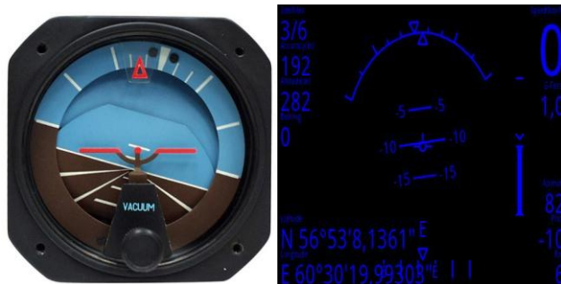
Рис.1. Авиагоризонт штатный прибор и авиагоризонт на базе смартфона андроид
