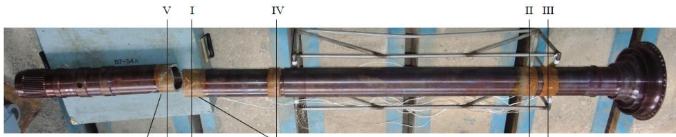
Рис. 3. Вал ТНД после циклического разрушения
