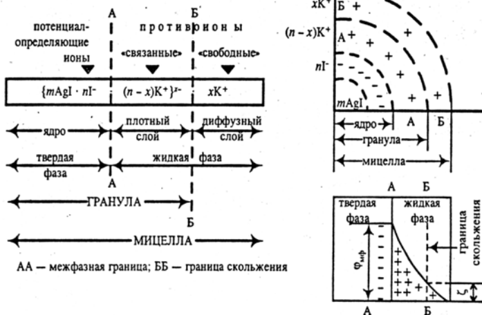
Рис. 1.1. Схема строения мицеллы иодида серебра в избытке иодида калия
