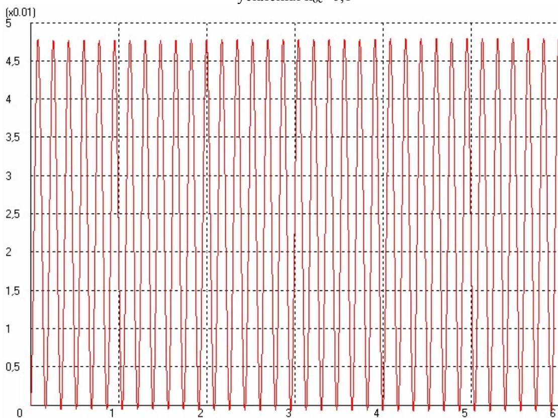
Рисунок 15 – График переходного процесса скорректированной САУ с коэффициентом усиления k_{oc}=42,35
