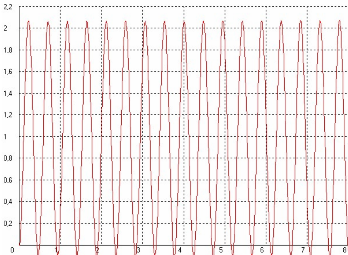
Рисунок 6 – График переходного процесса с коэффициентом усиления k=51,656 Исходная САУ является устойчивой. При изменении коэффициента усиления k=60 система становится неустойчивой, а при k=51,656 она находится на границе устойчивости.
