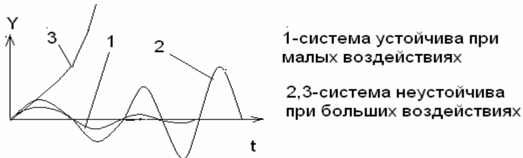
Рисунок 1 -Переходные процессы при различных воздействиях
