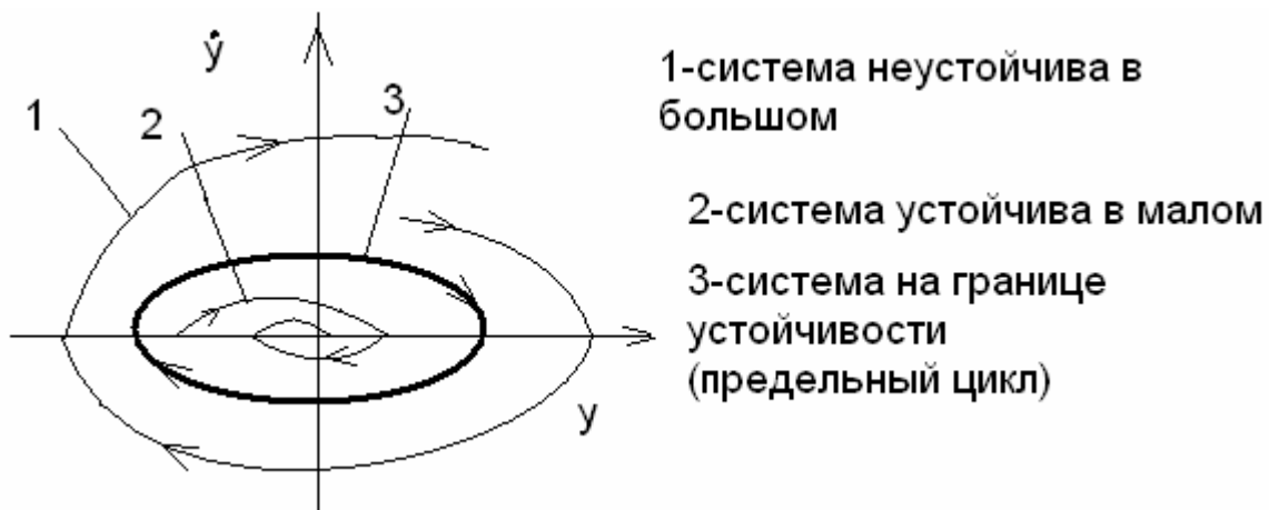
Рисунок 2 – Фазовые траектории нелинейной системы При наличии устойчивости фазовые траектории стягиваются к началу координат, а при неустойчивости – расходятся в бесконечность. Замкнутая траектория называется предельным циклом, ей соответствуют автоколебания, изображающая точка бесконечно движется по одной и той же замкнутой траектории.
