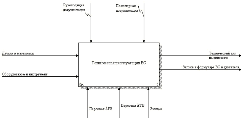
Рис. 7. Верхний уровень функциональной модели технической эксплуатации воздушных судов
