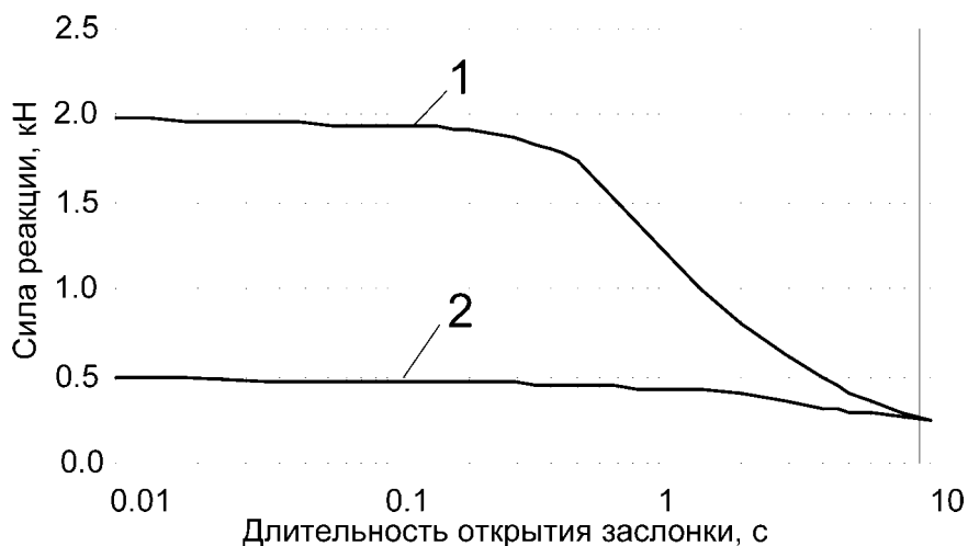
Рис. 4.2. Зависимость максимальной силы реакции потока жидкости во втором изгибе трубопровода от длительности открытия клапана №3 при
