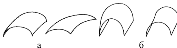
Рисунок 2.1 – Классификация оболочек двойной кривизны: а – оболочки с постоянными радиусами по главным сечениям; б – оболочки с переменными радиусами по главным сечениям.
