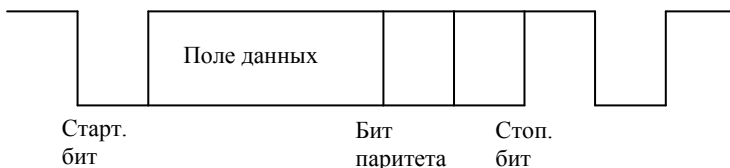
Рис. 3.9. Формат кадра асинхронного обмена
