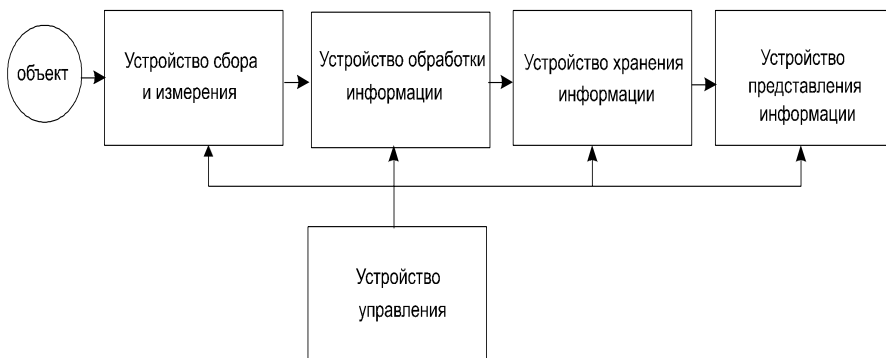
Рисунок 1 – Обобщенная структурная схема диагностической системы
