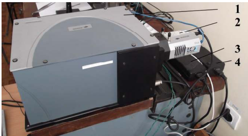
Рисунок 27 – Спектрометрический комплекс: 1 - спектрометр Shamrock sr-303i; 2 - встроенная охлаждаемая камера DV420A-OE; 3 - источник питания спектрометра; 4 – источник питания камеры
