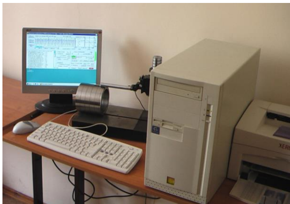
Рис.2. Автоматизированный профилограф-профилометр модели БВ-7669
