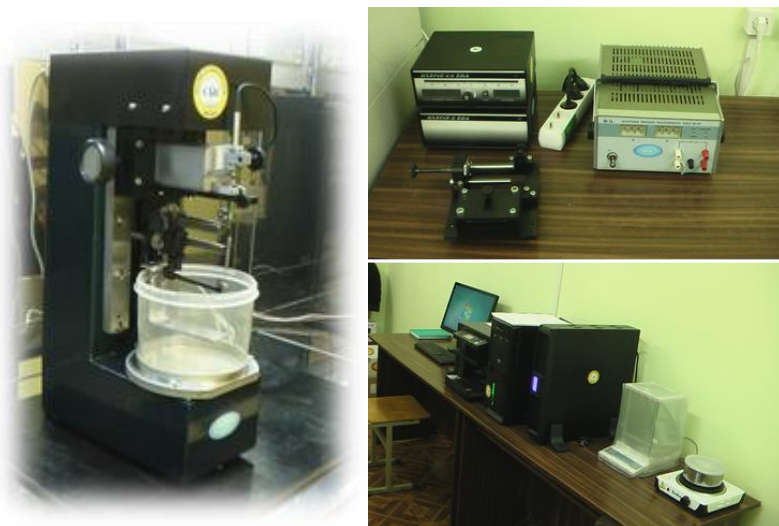
Рис.3. Автоматизированная установка для определения остаточных напряжений АСБ-1
