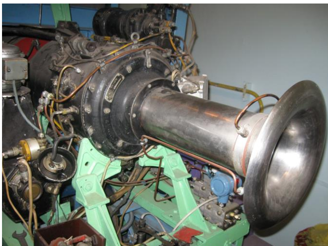
Рисунок 1 – Внешний вид ТРД ТС-12 на испытательном станке
