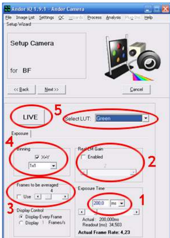
Рисунок 26 – Задание настроек камеры и вывода изображения: 1 – выбор времени экспозиции, 2 – управление электронным усилением, 3 – управление покадровым усреднением, 4 – сложение пикселей, 5 – запуск отображение изображения, 6 – режим отображения изображения
