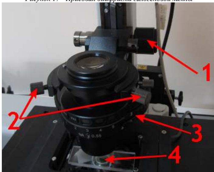
Рисунок 18 – Конденсор: 1- ручка регулировки высоты конденсора, 2 – ручки регулировки позиционирования, 3 - переключатель режима, 4 - объект исследования
