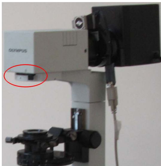
Рисунок 17 - Ирисовая диафрагма галогеновой лампы
