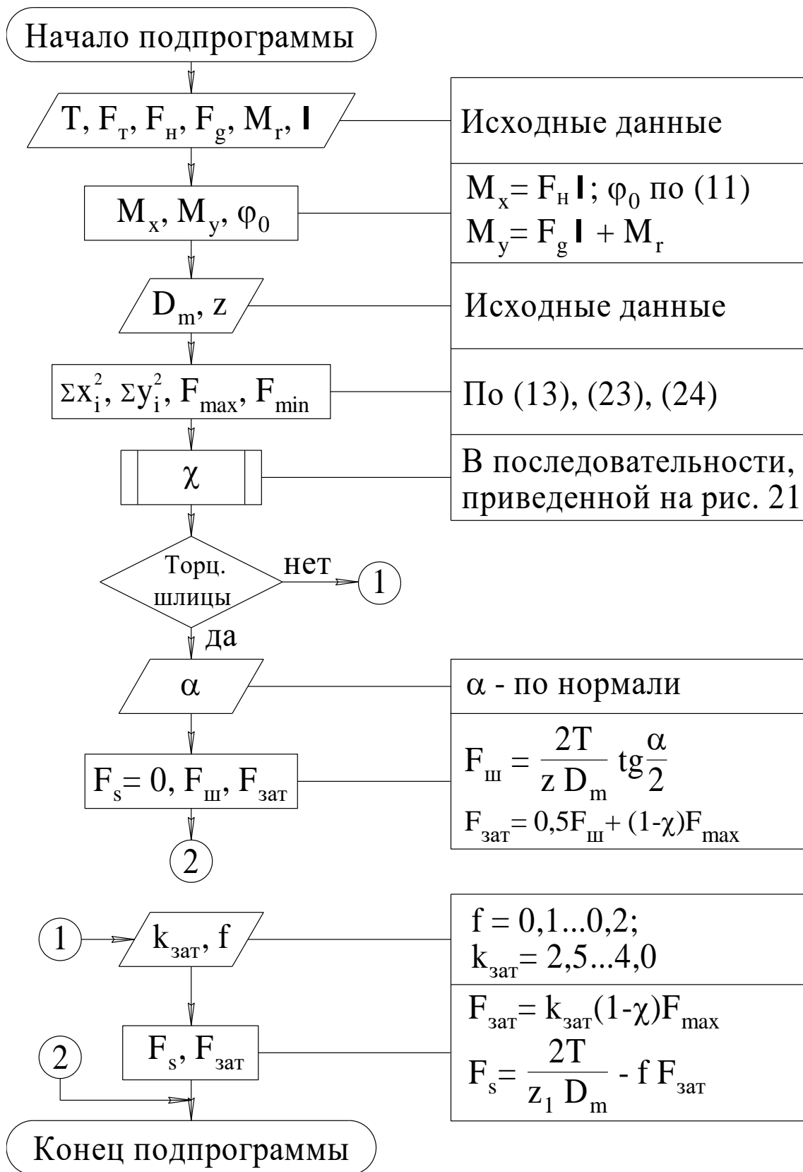
Рис. 20. Схема алгоритма определения нагрузок на максимально нагруженный болт для соединения вала и втулки винта
