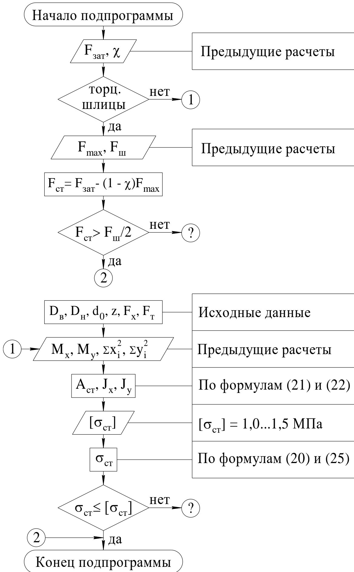
Рис. 25. Схема алгоритма проверки условия нераскрытия стыка фланцев
