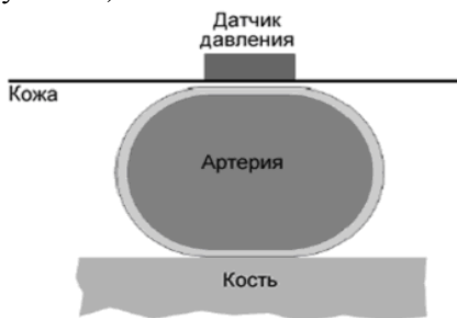
Рисунок 13 – Регистрация сигнала артериальной пульсации крови с помощью метода аппланационной сфигмографии
