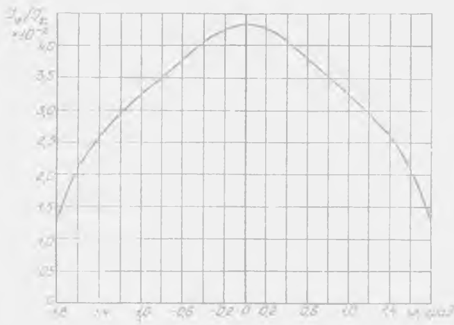
Рис. 11. Распределение интенсивности излучения в пучке азотного лазера по углу в дальней зоне
