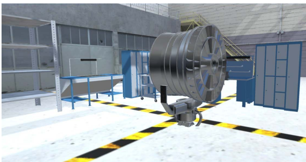
Рисунок 4.7 - Модель КНД двигателя НК-8 в виртуальном ремонтном ангаре
