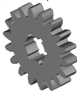
Рис. 54 3D модель цилиндрического зубчатого колеса
