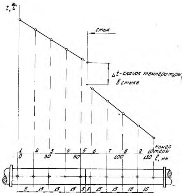
Р и с. 3. Распределение температуры по длине экспериментальных образцов
