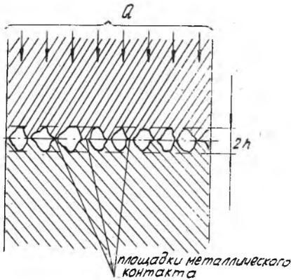
Р и с. 1. Схема стыка двух металлических деталей при сильном увеличении
