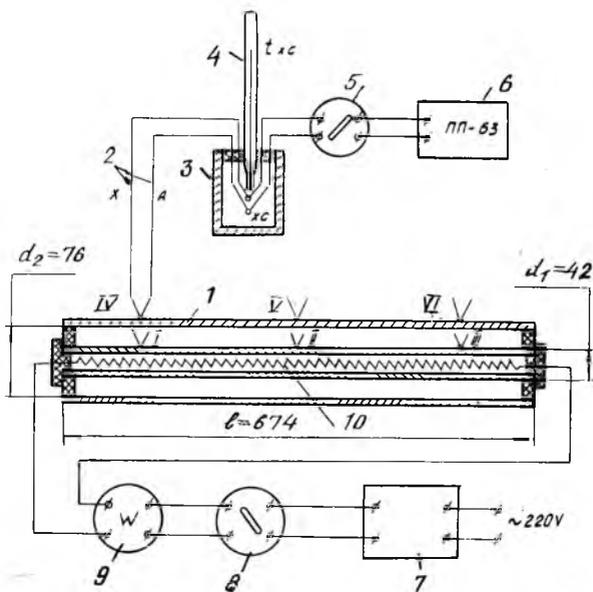
Р и с. Схема установки для определения теплопроводности сыпучих материалов методом труб
