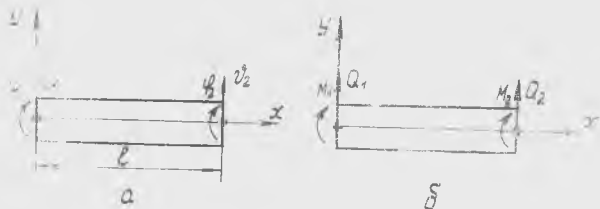
рис. 7. Конечный элемент: а - узловые перемещения; б - узловые силы
