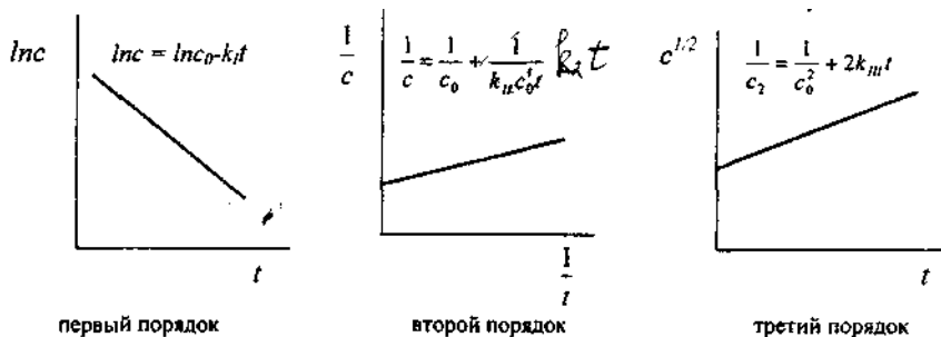
Рис. 1. Вид кинетических кривых для реакций I, II и III порядков ( c_0 и c — соответственно начальная и текущая концентрации исходного вещества; k_I , k_{II} , k_{III} — константы скорости реакции I, II, III порядков соответственно).
