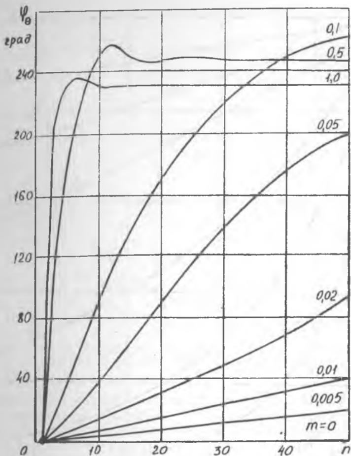
Рис. 26. Зависимость фазового сдвига тангенциальной компоненты скорости обтекания от расстояния до центра частицы
