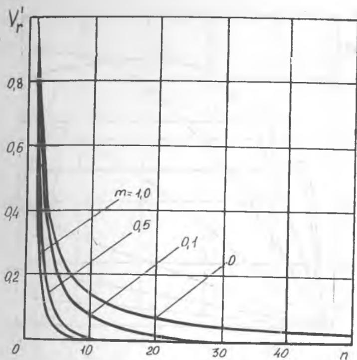
Рис. 1а. Зависимость радиальной компоненты скорости обтекания от расстояния до центра частицы
