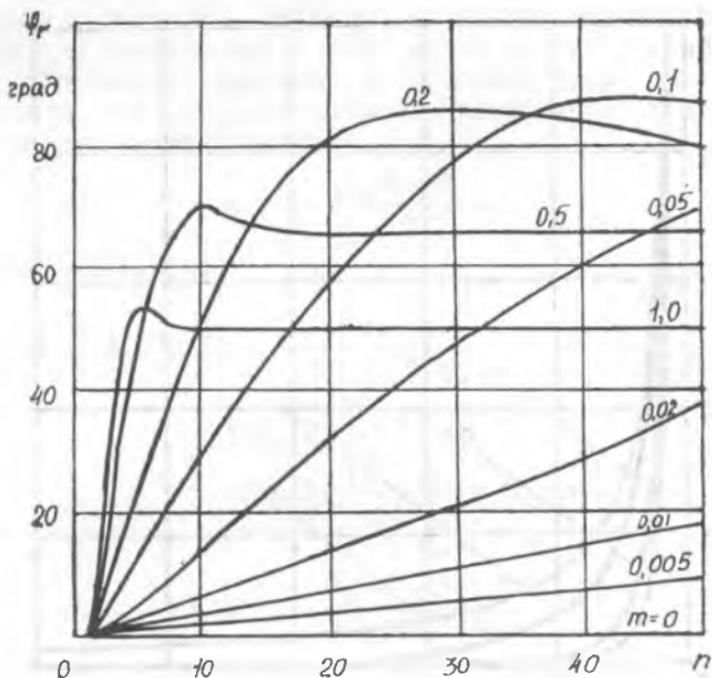
Рис. 2а. Зависимость фазового сдвига радиальной компоненты скорости обтекания от расстояния до центра частицы
