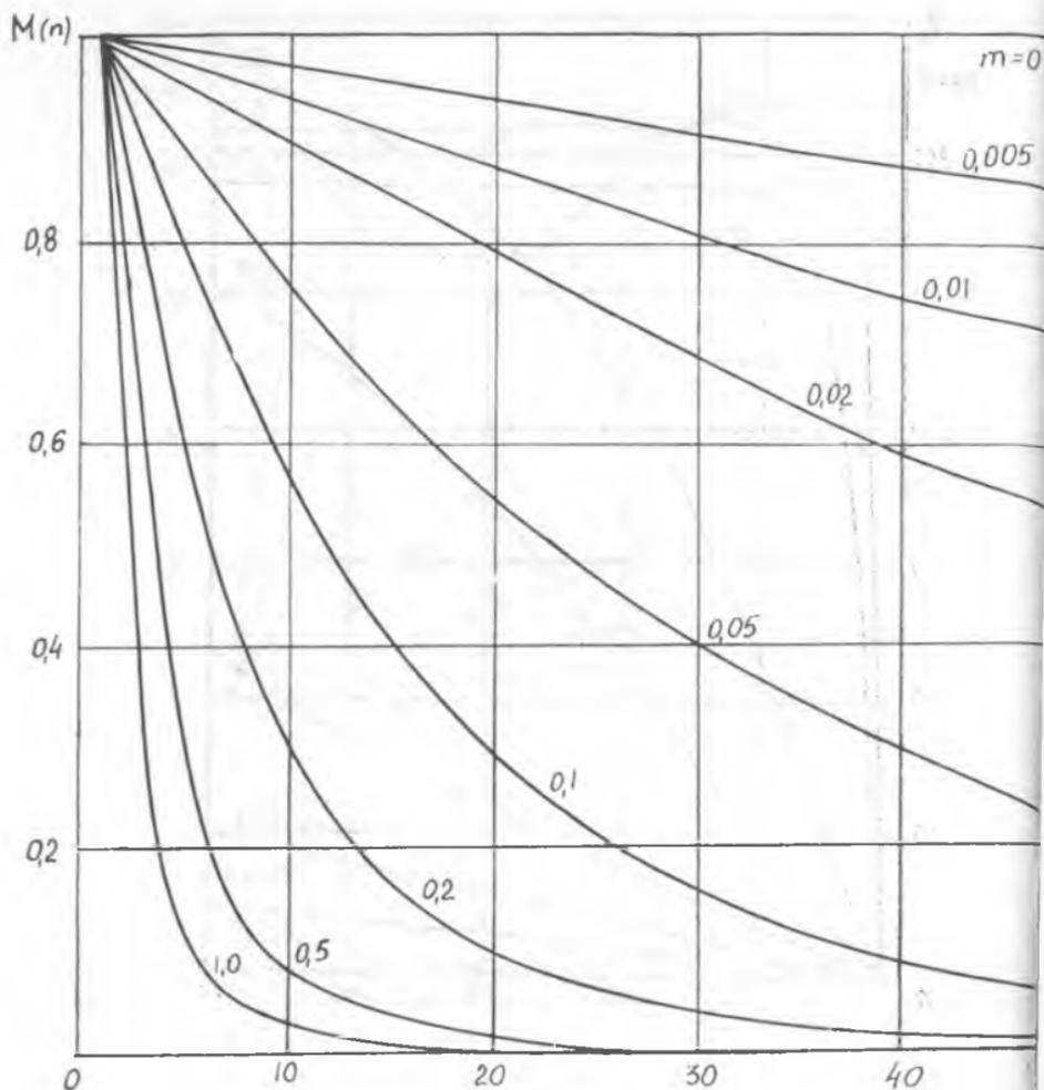
Рис. 3. Зависимость нормированной радиальной компоненты скорости обтекания от расстояния до центра частицы
