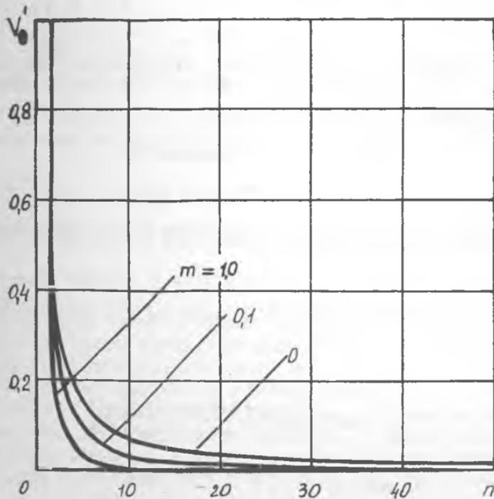
Рис. 1б. Зависимость тангенциальной компоненты скорости от расстояния до центра частицы
