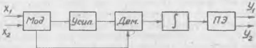
Блок-схема сравнивающего устройства:  $x_1$  и  $x_2$  - сравниваемые напряжения
