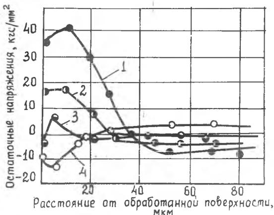
Р и с.3. Тангенциальные остаточные напряжения. Обработываемый материал ЭИ643. 1 -  $v_d = 15$  м/мин; 2 -  $v_d = 46$  м/мин; 3 -  $v_d = 64$  м/мин; 4 -  $v_d = 85$  м/мин
