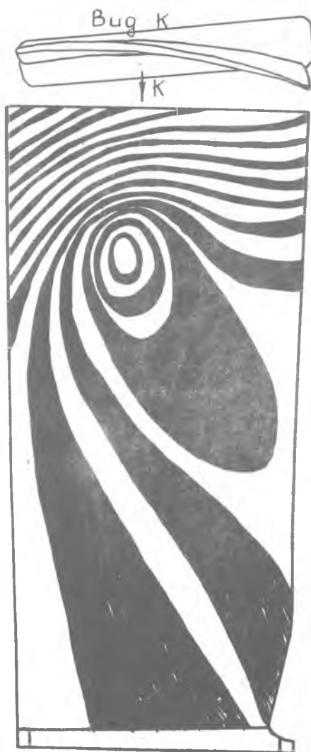
Рис.5.Интерферограмма компрессорной лопатки
