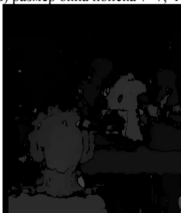
Рисунок 5. Результат вычисления по алгоритму Block-Matching.
