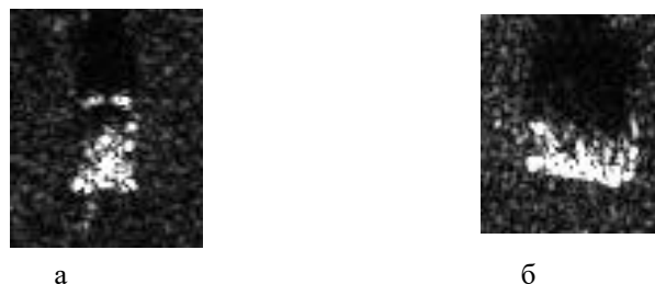
Рис. 7. РИ танка из базы MSTAR а) угол азимута 17°, угол места 1°; в) угол азимута 17°, угол места 93°.
