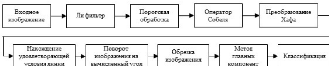
Рисунок 3. Алгоритм предварительной обработки с использованием метода, основанного на нахождении прямоугольника минимальной площади.
