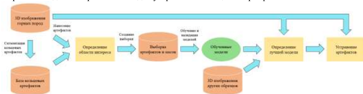
Рисунок 1. Диаграмма построения модели нейронной сети для устранения кольцевых артефактов.
