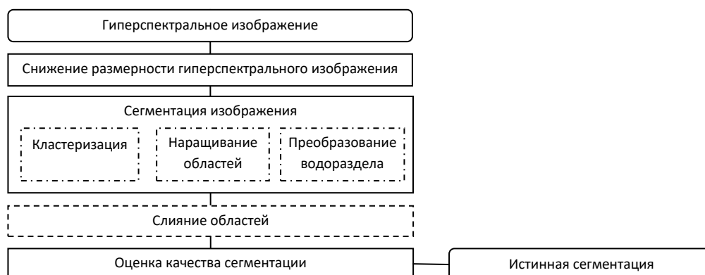
Рис. 1. Общая схема сегментации. Альтернативные методы показаны штрих-пунктирными линиями, необязательный элемент показан пунктирными линиями.
