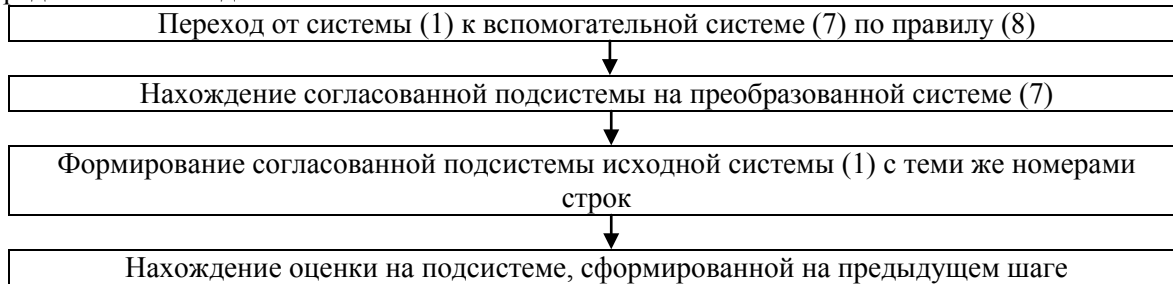
Рисунок 1. Алгоритм согласованного оценивания с редукцией столбцов.
