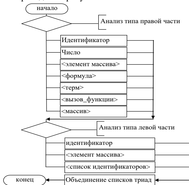
Рис.1. Укрупнённый алгоритм генерации триад оператора присваивания
