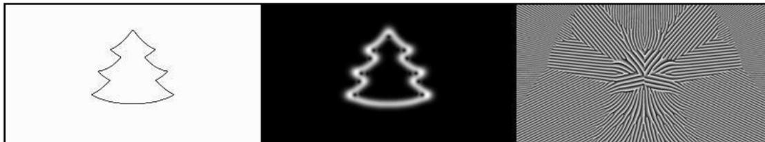
Рисунок 2. Порождающая кривая, интенсивность и фаза спирального пучка в градациях серого.
