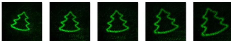
Рисунок 4. Полученные распределения интенсивности спирального пучка с шагом 4 см от плоскости фокусировки  $F = 42$  см.
