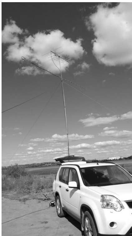
Рисунок 4. Стационарная приемная станция, развернутая в полевых условиях.
