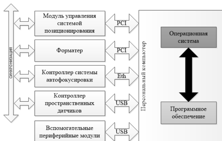
Рисунок 2. Структурная схема ЭБ ЛНЛКС.
