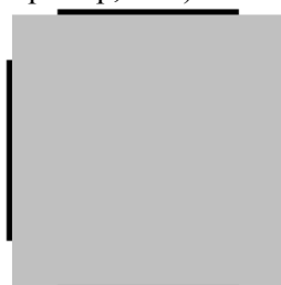
Рисунок 1. Геометрия управляющего электрода. Серый цвет – управляющий электрод, черный цвет – контактные электроды.
