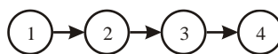
Рис. 1. Макрограф алгоритма циклической прогонки (1 - определение прогоночных коэффициентов, 2 – вычисление значений промежуточных сеточных функций, 3,4 – поиск значений искомой сеточной функции)
