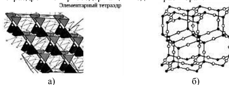
Рисунок 9. Возможные модели образования клатратов в водных растворах этанола (а) и глицерина (б) (вид сверху).
