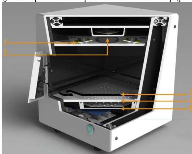
Рисунок 1. Вид измерительной установки в разрезе: 1 – верхняя подсветка, 2 – камера с объективом, 3 – кассета для размещения образцов анализа, 4 – светорассеивающая пластина, 5 – нижняя подсветка.
