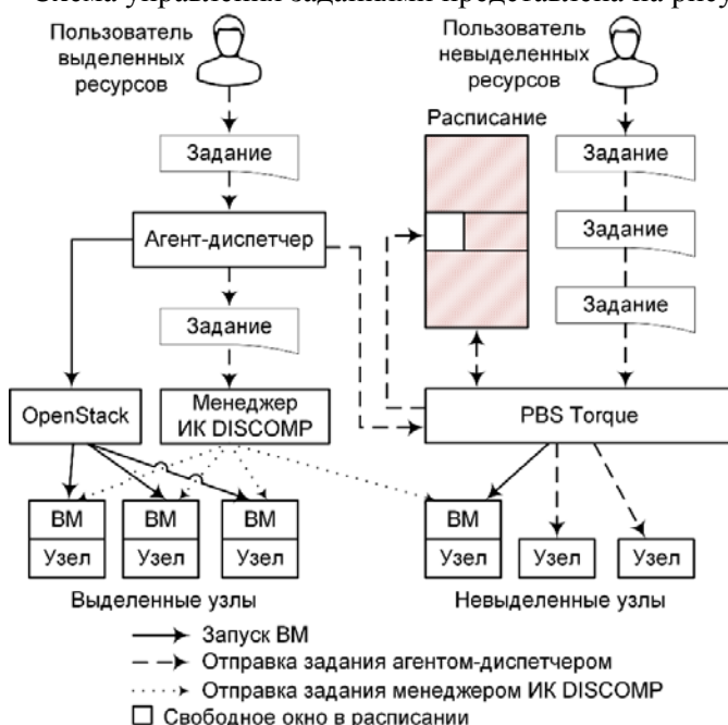
Рисунок 1. Схема мультиагентного управления заданиями пользователей в гетерогенной распределенной вычислительной среде с применением виртуальных машин.
