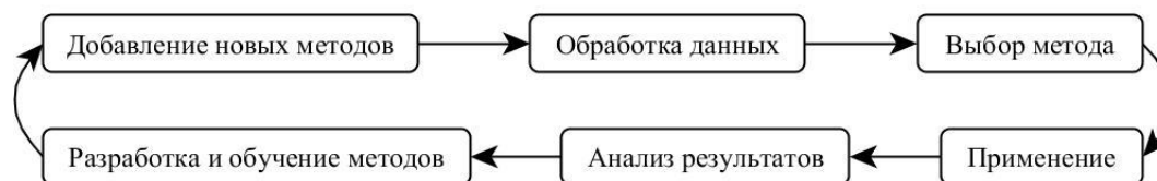
Рисунок 1: Жизненный цикл методов обработки данных ДЗЗ
