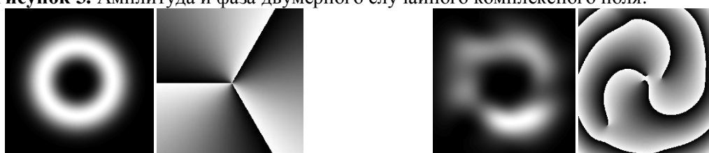
До прохождения через случайную среду После прохождения через случайную среду Рисунок 4. Интенсивность и фаза оптического поля, соответствующего моде однокольцевой моде Лагерра-Гаусса с порядком оптического вихря, равным 3.
