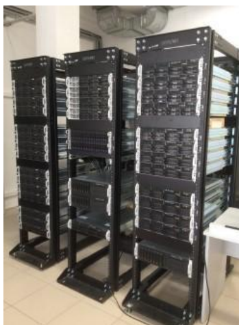
Рис. 5. Многомашинный вычислительный комплекс (кластер) для осуществления параллельных и распределённых вычислений и хранения результатов.
